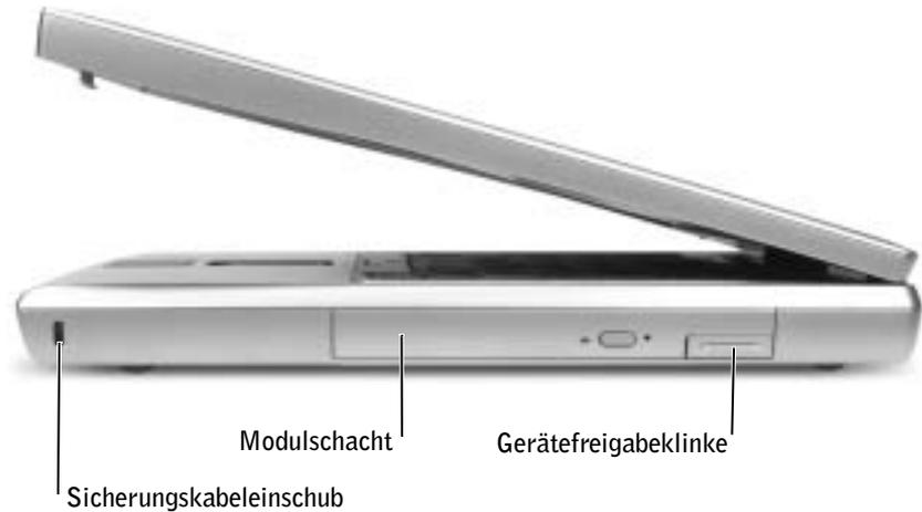
**SICHERUNGSKABELEINSCHUB** – Hiermit kann eine handelsübliche Diebstahlschutzvorrichtung an den Computer angeschlossen werden. Weitere Informationen können Sie den Anweisungen entnehmen, die im Lieferumfang des Gerätes enthalten sind.
