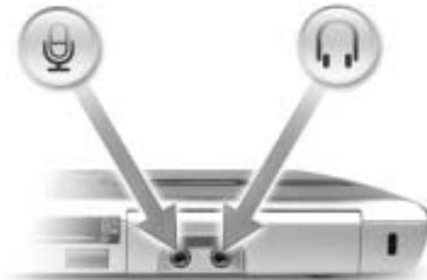
An den mit dem Symbol
