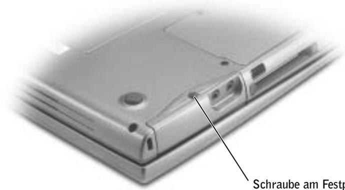
Schraube am Festplattenlaufwerk
